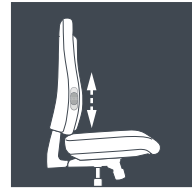
Schienale con supporto della lordosi regolabile in altezza
