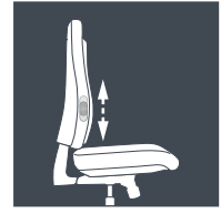
Rückenlehne mit höhenverstellbarer Lordosenstütze
