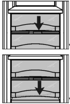
► **Ablauföffnung** reinigen: Ablagerungen mit einem dünnen Hilfsmittel, z. B. einem Wattestäbchen entfernen.
