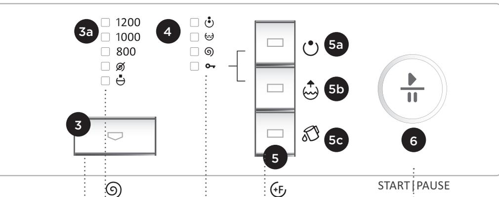
**3** Taste AUSWAHL der SCHLEUDERDREHZAHL (Schleudern) / PUMPEN/ PUMPE STOP
