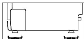
Wenn das Gerät zum Ausrichten aufgestellt worden ist, kann die Höhe über die Einstellschrauben an den Füßen verändert werden. Auf keinen Fall sollte das Gerät mehr als 2° geneigt werden.
