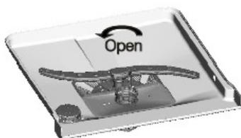
Schritt 1: Filter gegen den Uhrzeigersinn drehen.
