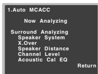
Eine Statusanzeige erscheint auf dem Bildschirm, während der Receiver weitere Testtöne abgibt, um die optimalen Receiver-Einstellungen für Kanalpegel, Lautsprecherentfernung und Acoustic Calibration EQ zu ermitteln.
