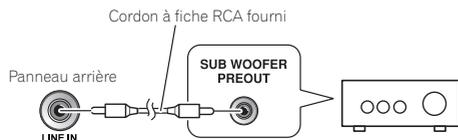
Raccordez la borne **LINE IN** de l'appareil sur la borne **SUBWOOFER PREOUT** du récepteur au moyen du cordon à fiche RCA fourni.
