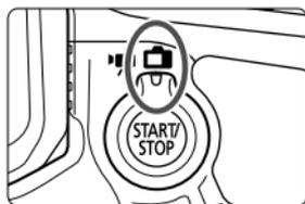
Es ist möglich, Aufnahmen zu machen, während ein Bild am LCD-Monitor der Kamera angezeigt wird. Dies wird als „Livebild-Aufnahme“ bezeichnet. Stellen Sie zum Aktivieren der Livebild-Aufnahme den Schalter für Livebild-Aufnahmen/Movie-Aufnahmen auf <
