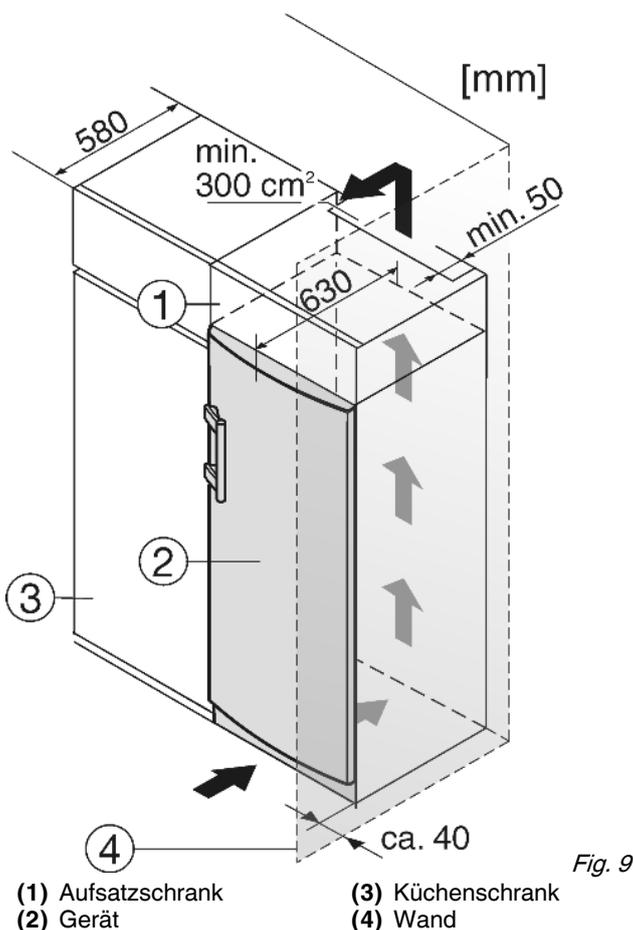
Beim Umbau mit Küchenschränken (Tiefe max. 580 mm) kann das Gerät direkt neben dem Küchenschrank *Fig. 9 (3)* aufgestellt werden. Die Gerätetür steht seitlich 34 mm und in der Gerätemitte 50 mm gegenüber der Küchenschrankfront vor. Sie lässt sich dadurch einwandfrei öffnen und schließen.
