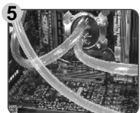
Bitte stellen Sie sicher, dass die Flüssigkeit kontinuierlich und reibungslos in der Röhre fließt.
