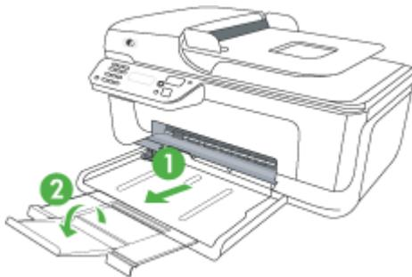
2. Legen Sie die Druckmedien mit der zu bedruckenden Seite nach unten entlang der rechten Seite des Hauptfaches ein. Achten Sie darauf, dass der Medienstapel rechts und hinten am Fach anliegt und nicht über die Begrenzungslinie im Fach herausragt.
