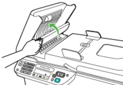
5. Reinigen Sie den Kunststoffstreifen mit einem mit mildem Glasreiniger befeuchteten weichen Tuch oder Schwamm.
