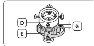
4. Schließen Sie den Adapter an den Wasserhahn an. Ziehen Sie dazu den Adapter nach oben, während Sie die Schrauben festdrehen. Ziehen Sie anschließend den Adapter fest, indem Sie **Teil (E)** in Pfeilrichtung drehen.
