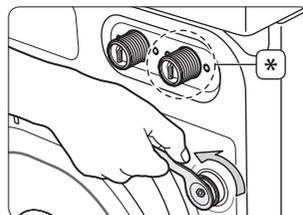
2. Halten Sie die Transportsicherung mit dem Schraubenschlüssel, und ziehen Sie sie durch die breite Aussparung an der Öffnung. Dieser Vorgang muss für alle Transportsicherungen ausgeführt werden.
