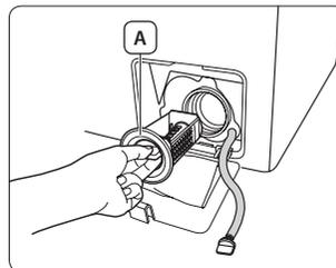
4. Reinigen Sie die Fremdkörperfalle, und entfernen Sie etwaige Fremdkörper. In der Waschmaschine befindet sich hinter der Fremdkörperfalle das Propellerrad der Absaugpumpe. Stellen Sie sicher, dass dieses Rad nicht blockiert ist.
