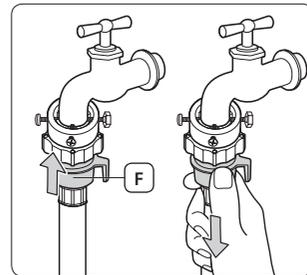
6. Drehen Sie den Wasserhahn auf, und prüfen Sie, ob Wasser aus dem Wasserventil, Hahn oder Adapter austritt. Sollte tatsächlich Wasser austreten, müssen Sie die vorherigen Schritte wiederholen.
