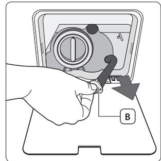
5. Halten Sie die Kappe am Ende des **Notentleerungsschlauchs (C)**, und ziehen Sie diesen langsam heraus.
