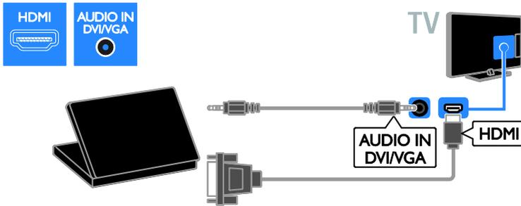
Schließen Sie den Computer über ein VGA-Kabel und ein Audiokabel am Fernseher an.
