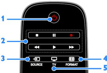
1. **⏻ (Standby)**: Anschalten des Fernsehers oder Wechseln in den Standby-Modus.
