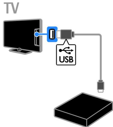
4. Schalten Sie den Fernseher und die USB-Festplatte ein, falls diese über eine externe Stromversorgung verfügt.
