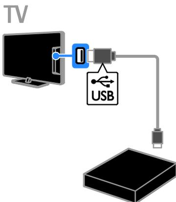
4. Schalten Sie den Fernseher und die USB-Festplatte ein, falls diese über eine externe Stromversorgung verfügt.
