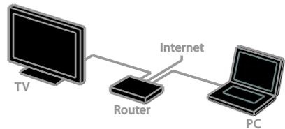
Sie können diesen Fernseher per WLAN oder per Kabel an Ihr Heimnetzwerk anschließen.
