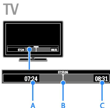
1. Drücken Sie **III** auf einem digitalen Sender, um eine Fernsehsendung zu pausieren.
