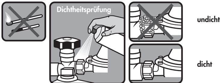
Abb. 2: Dichtheitsprüfung
