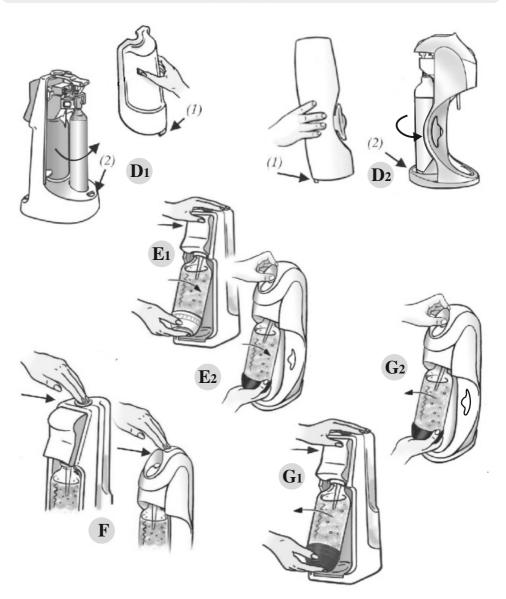
So tauschen Sie einen leeren Zylinder aus / Pour remplacer un cylindre vide / Verwisselen van een lege cilinder / Sostituzione di un cilindro vuoto / Paracambiar un cilindro vacio / Ersätta tom cylinder / Å erstatte en tom sylinder / Udskiftning af tom patron / Tyhjän patruunan vaihtaminen / Ballooni vahetamine / Cilindro keitimas / Tukšā cilindra noņemšana / Замена пустого баллона / Polish / Hungry / Montáž bombičky / Montáž bombičky / Zamjena praznog cilindra / Menjava prazne jeklenke / 시작.
