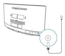
Verbinden Sie die UKW-Antenne mit dem Produkt.
