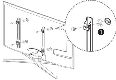
Beim Einbau einer Wandhalterung, verwenden Sie den Haltering . ❶.
