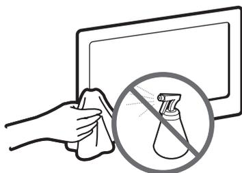
Sprühen Sie kein Wasser oder Reinigungsmittel direkt auf das Gerät. Jede Flüssigkeit, die in das Gerät eindringt, kann zu einer Funktionsstörung, einem Brand oder einem Stromschlag führen.
