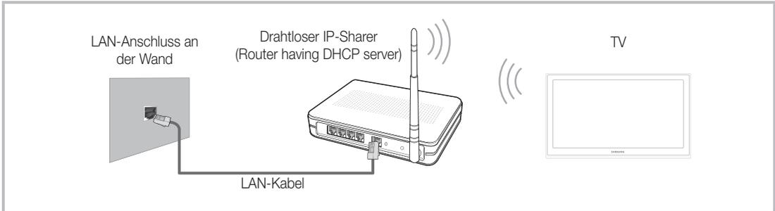
Der Samsung WLAN-Adapter unterstützt die Kommunikationsprotokolle IEEE 802,11a/b/g und n. Samsung empfiehlt, IEEE 802,11 n zu verwenden. Wenn Sie Video über die IEEE 802,11b/g-Verbindung anzeigen, wird das Videobild möglicherweise nicht ohne Unterbrechungen angezeigt.
