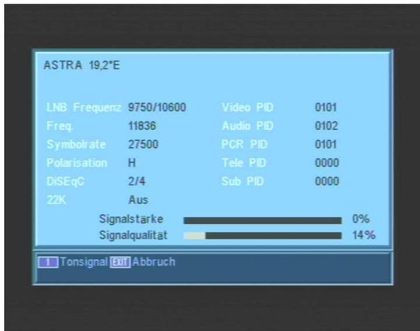
Nun können Sie zu Ihrer Antenne gehen um diese einzurichten. Sie werden feststellen, dass die LED auf Ihrem Easy Find LNB angefangen hat in der Farbe Rot zu blinken. Es ist somit aktiv und die Antenne kann nun eingerichtet werden auf den von Ihnen ausgewählten Satellit.
