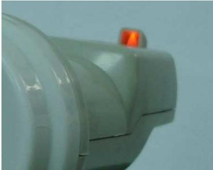
Sind Sie auf dem richtigen Satelliten, muss es möglich sein, die Antenne so einzustellen, dass die LED Diode durchgehend grün leuchtet. Dies kann nur bei dem von Ihnen im Menü des Receivers ausgewählten Satelliten der Fall sein.
