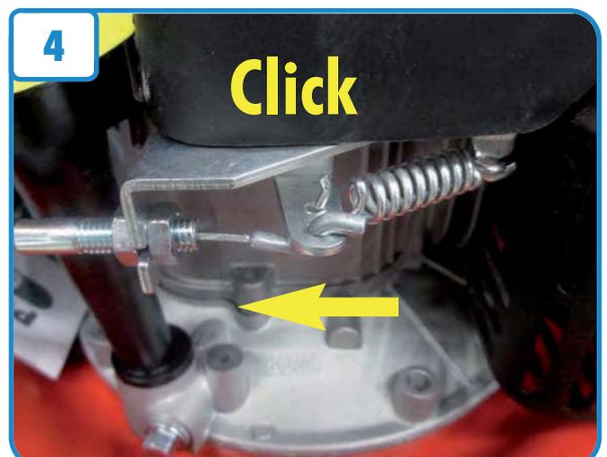
Wenn beim Betätigen des Totmannbügels ein Klickgeräusch zu hören ist, wird der Mikroschalter betätigt und es kann erneut gestartet werden.
