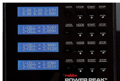
Auf einen Blick lesbar: die Zellenspannung von sechs Zellen oder, mit einer höheren Auflösung, von zwei Zellen
