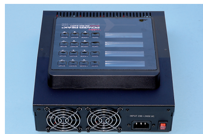
Netzanschluss und Schalter auf der Rückseite. Der erforderliche Platz sorgt für freie Lüfter
