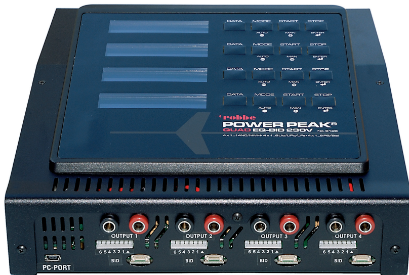
Vier vollwertige Ladegeräte, alle mit BID-Chip-Anschluss
