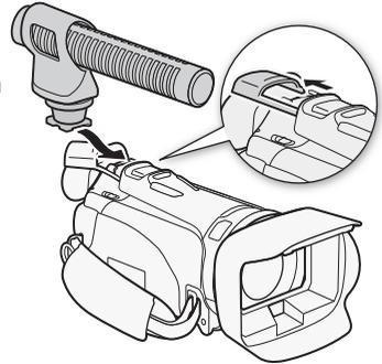
Beispiel: Anbringen eines optionalen Stereo-Richtmikrofons DM-100.
