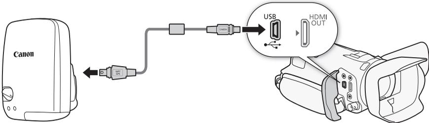
Wenn Sie den GPS-Empfänger GP-E2 an den Camcorder anschließen, verwenden Sie dazu das mit dem Empfänger mitgelieferte Anschlusskabel. Nachdem Sie den Empfänger angeschlossen haben, empfehlen wir, ihn am Griffriemen oder an der mit dem Empfänger mitgelieferten Tragetasche zu befestigen.
