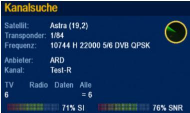
Während der Kanalsuche werden alle wichtigen Daten angezeigt. In diesem Beispiel den Satelliten **Astra 19,2** auf dem **84 Transponder** gefunden wurden, wovon aktuell der **1te Transponder** mit der **Frequenz 10.744 MHz** gescannt wird. Auf dieser **Frequenz** sendet der **Anbieter ARD** unter anderem den **Kanal Test-R**.
