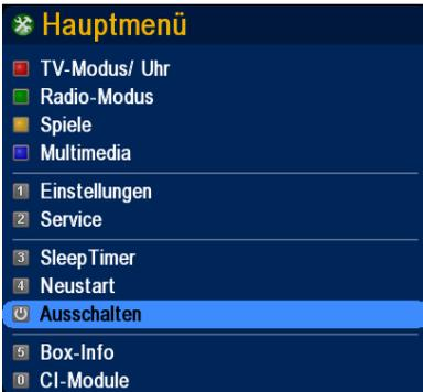
Der Deep-StandBy der Coolstream NEO<sup>2</sup> wird im Hauptmenü über die Option **Ausschalten** aktiviert. Im Deep-StandBy ist der Strom Verbrauch sehr niedrig (<1Watt). Timeraufnahmen werden aber durch den integrierten Frontprozessor auch im DeepStandBy bearbeitet und die Box hierzu automatisch "aufgeweckt".
