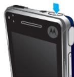
Um die Zeitspanne bis zur automatischen Deaktivierung zu ändern, drücken Sie die Menütaste
