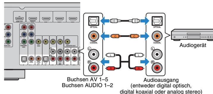
Wenn Sie die Eingangsquelle durch Drücken von AV 1-5 oder AUDIO 1-2 auswählen, werden die am Audiogerät abgespielten Audiosignale am Gerät ausgegeben.
