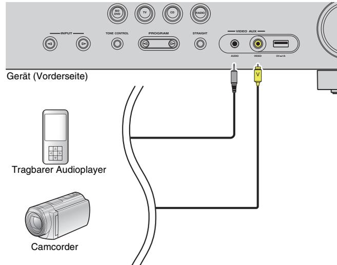
Wenn Sie mit V-AUX die Eingangsquelle „V-AUX“ auswählen, werden die am Videogerät abgespielten Video-/Audiosignale am Gerät ausgegeben.
