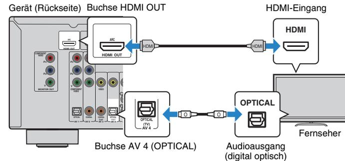
Wenn Sie mit der Taste AV 4 oder SCENE(TV) die Eingangsquelle des Geräts auf „AV 4“ umschalten, wird der Fernsehton am Gerät ausgegeben.
