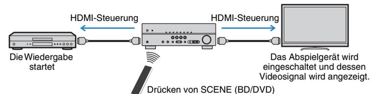
Um die HDMI-Steuerung zu verwenden, müssen Sie nach Anschluss des Fernsehers und der Abspielgeräte die folgende Einrichtung der HDMI-Steuerungskopplung vornehmen.
