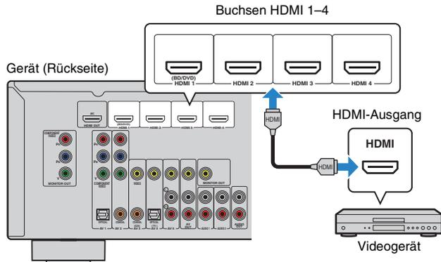
Wenn Sie die Eingangsquelle durch Drücken von HDMI 1–4 auswählen, werden die am Videogerät abgespielten Video-/Audiosignale vom Gerät ausgegeben.
