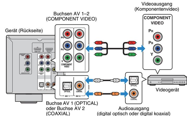
Wenn Sie die Eingangsquelle durch Drücken von AV 1–2 auswählen, werden die am Videogerät abgespielten Video-/Audiosignale vom Gerät ausgegeben.
