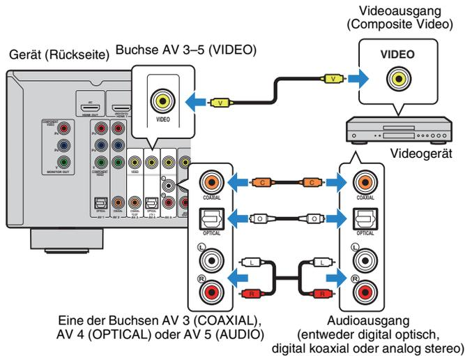
Wenn Sie die Eingangsquelle durch Drücken von AV 3-5 auswählen, werden die am Videogerät abgespielten Video-/Audiosignale vom Gerät ausgegeben.
