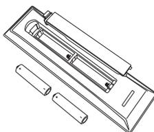
Entfernen Sie die Abdeckung von der Rückseite, um Batterien in das Batteriefach einzulegen. Achten Sie dabei auf die richtige Polung. Diese Fernbedienung verwendet den Batterietyp AAA, 1,5V.
