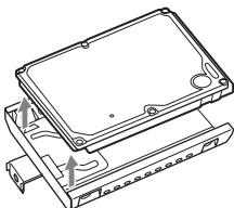
**3 Plaats de vervangende harde schijf op het metalen kader voor de harde schijf van het PS3™-systeem en bevestig ze vervolgens met de schroeven (4 plaatsen).**
