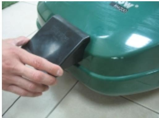
Das Ladesystem und die Batterie sind so konstruiert, dass sie angeschlossen bleiben können, wann immer sie nicht genutzt werden, ohne dass Sie Überladung, Überhitzung oder einen Schaden an der Batterie befürchten müssen.
