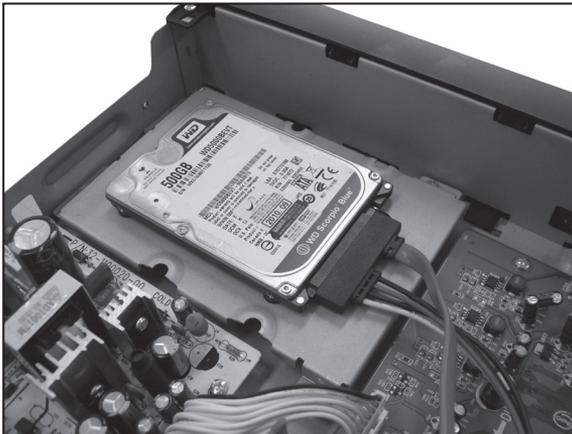
Ansicht mit eingebauter 2.5" HDD.
