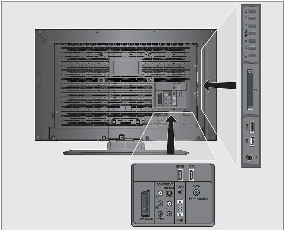
**AV1 / S-VHS** Euro/AV-Buchse (FBAS-Signal, RGB-Signal); Bildsignal-Buchse für S-Video-Camerarecorder.
