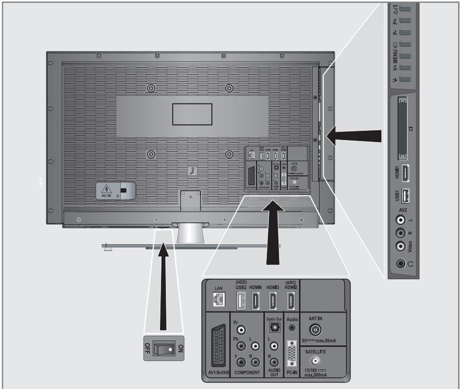
**AV1 / S-VHS** Euro/AV-Buchse (FBAS-Signal, RGB-Signal); Bildsignal-Buchse für S-Video-Camerarecorder.
