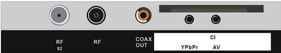
Verbinden Sie das Gerät über ein Koaxialkabel (nicht mitgeliefert) mit dem Verstärker oder anderen Audiodekodierern zur Ausgabe koaxialer Audiosignale.
