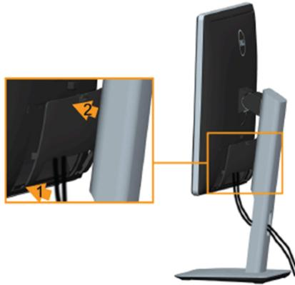
1. Passen Sie die Vertiefung an der Rückseite des Monitors in die beiden Nasen am Unterteil der Kabelabdeckung ein.
