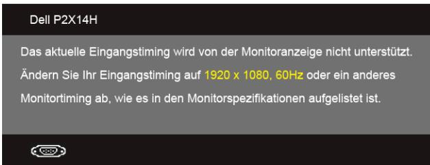
Das bedeutet, dass sich der Monitor nicht richtig auf das Signal einstellen kann, das er vom Computer empfängt. In den [Technische Daten des Monitors](#) finden Sie die von Ihrem Monitor unterstützten Horizontal- und Vertikalfrequenzen. Die empfohlene Auflösung beträgt 1920 x 1080.
