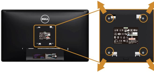
(Schraubenabmessung: M4 x 10 mm).
