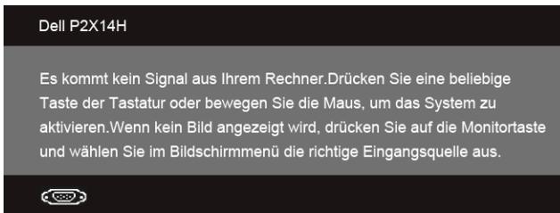
Wenn der VGA-, DVI-D- oder DP-Eingang ausgewählt ist, aber das entsprechende Kabel nicht angeschlossen ist, wird das nachstehend gezeigte Dialogfeld eingeblendet.
