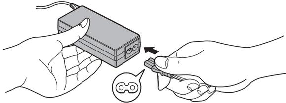
*Abbildung 2-2 Netzkabel an den Netzadapter (mit 3 Kontakten) anschließen*
