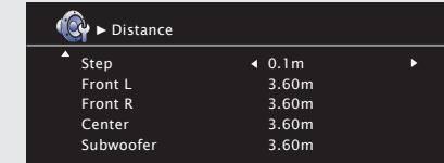
**2 Ändern Sie mit ◄ ► den Schritt (kleinste Variable für die Entfernung).**
